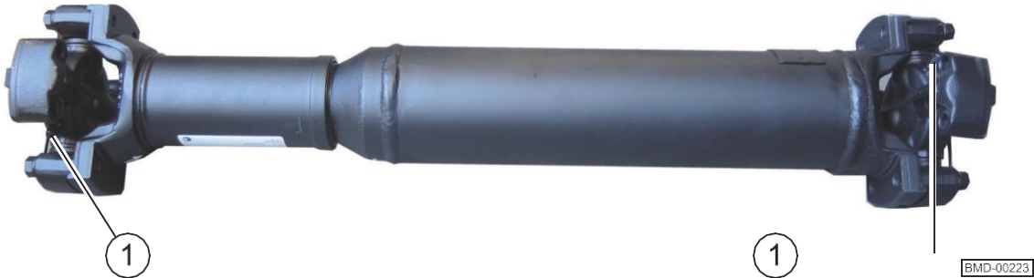
Fig 9.6: Puntos de lubricación de los árboles cardán
