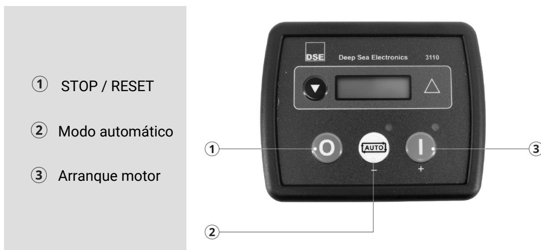
Imagen 12: Disposición modos de operación placa de control DSE 3110.
