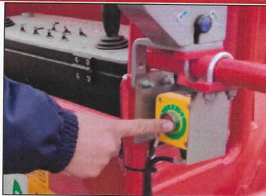
Figura - Interruptor de Restablecimiento 1
