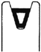
Correa del ventilador en mal estado
