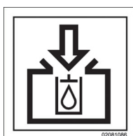
Llenado de depósito de aceite hidráulico
